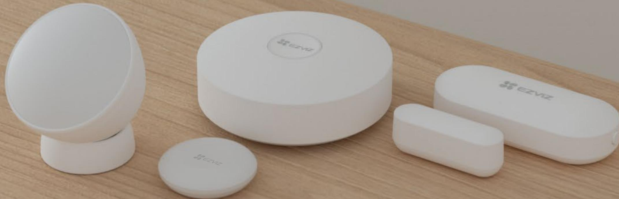
1 Das Gateway für Zuhause ist nicht batteriebetrieben und muss an eine Steckdose angeschlossen werden. Die Sensoren und die Taste sind batteriebetrieben. Knopfzellen sind im Lieferumfang enthalten.
